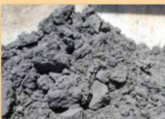
⑧バグフィルタで集められた飛灰は、灰固化装置によって薬剤処理され、固形物バンカに貯留されます。ごみ量の約4%が飛灰固化物となります。
