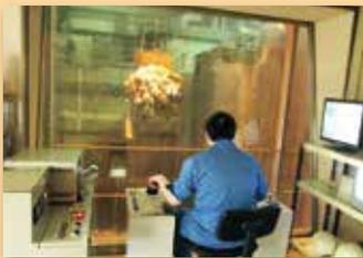
③ごみピットに投入されるごみは、大きさも燃焼性もそれぞれ異なるため、ごみクレーンで十分に攪拌し、ごみ質を均一にしてから焼却炉に投入します。安定した燃焼には欠かせない重要な作業の一つです。
