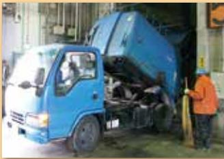
②プラットホームから、ごみピットへ投入し、一時的に貯留されます。貯留されたごみは、計画的に処理されます。
