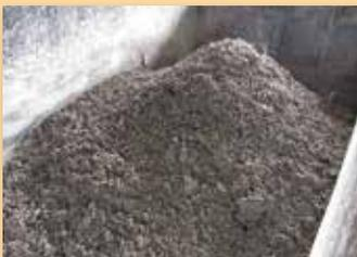
⑥焼却灰は、焼却炉から灰出コンベヤへ落下し、水を潜り灰バンカに貯留されます。ごみ量の約8%が焼却灰となります。
